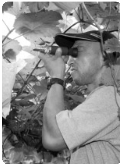
ブドウの糖度は糖度計により測定します。
