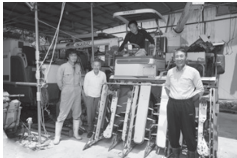
元々は3台の部品を合体修理した中古コンバイン（3世代4人で最後まで徹底的に使う）
